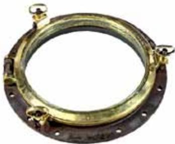
**15 - Hublot ouvrant à trois clés**, le tout en laiton et monté sur son châssis en acier. En provenance du paquebot MERMOZ et frappé sur le châssis de la Société SMF GSC. Douze trous d'ancrage sur la ceinture en acier. Ces hublots étaient à l'origine peints en blanc. Ils vous sont présentés ici décapés et polis. Diamètre total 53 cm. Diamètre vitre : 40 cm. Epaisseur : 7 cm. Bon état.
