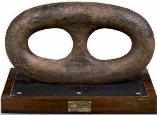
**37 - Maillon de la chaîne d'ancre avant tribord du paquebot FRANCE.** Cette chaîne en acier rond de 7 cm de diamètre, fut réalisée par la société VEILLE au HAVRE. Le poids de chaque maillon était à l'origine de 35 kilos, l'usure et la corrosion ont fait perdre à certains d'eux jusque 5% de leur poids initial.
