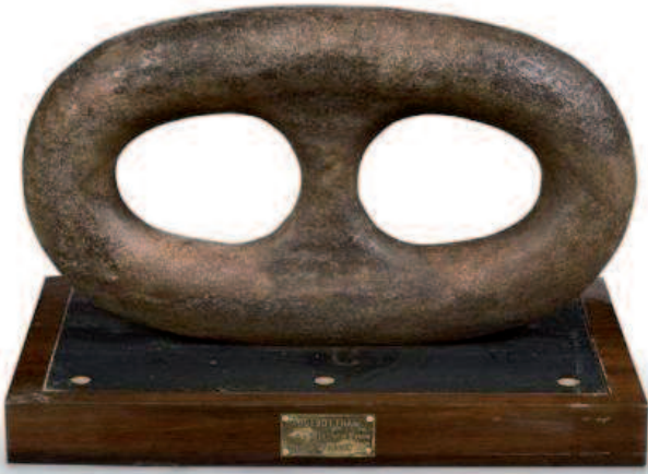
7 - Maillon de la grande chaîne d'ancre d'étrave du paquebot FRANCE. Cette chaîne en acier rond de 9 cm de diamètre fut réalisée par la société VEILLE au HAVRE. Le poids de chaque maillon était à l'origine de 70 kilos, l'usure et la corrosion ont fait perdre à certains d'eux jusqu'à 5% de leur poids initial. Chaque maillon a nécessité la découpe des deux maillons aux extrémités. Adapté après démontage sur une base en teck pour la présentation. Longueur : 54 cm. Largeur : 34 cm. Bon état.
